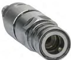
für Vikan Schaumspritze, zur Verhinderung des Rückflusses von Reinigungsmittel in die Trinkwasserversorgung, zugelassen nach EN 1717, Stoffe der Klasse 3 Abm. L 135 mm, Dm 32 mm, inkl. Schlauchbinde, Material: Messing min. 10 bis max. 25 bar Wasserdruck
