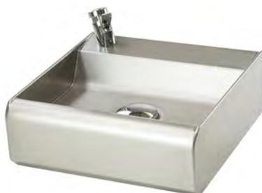
aus Edelstahl 1.4301; zur Wandbefestigung Rückwand, inkl. Wandbefestigungsschiene mit mechanischer Trinkbrunnenarmatur, Messing verchromt voll verschweisster Beckenkörper für eine optimale Reinigung durch grosszügige Radien; Oberflächen gebürstet
