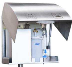
Die Kopfblende lässt sich zum Austausch / Nachfüllen von Flüssigseife oder Desinfektionsmittel leicht aufklappen und wird mittels Gasdruckfeder in der geöffneten Position gehalten
