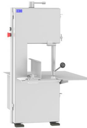
inkl. Streifenschneidvorrichtung, Andruckvorrichtung, Knochenmehlbehälter, autom. Spannkontrolle sowie Motorbremse, Notstopp, Schutzart IP65
