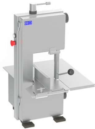
inkl. Streifenschneidvorrichtung, Andruckvorrichtung, autom. Spannkontrolle sowie Motorbremse, Notstopp
