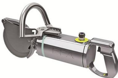
Hochleistungs-Zerlegesäge mit wartungsfreiem, energiesparendem Servosynchronmotor mit einem höheren Durchzugsmoment bei kleinerer Bauart. Längere Standzeit durch integrierte Regelelektronik, verschleissarm, wartungsfreier Motor, leicht und sicher zu Reinigen, hoher Sicherheitsstandard durch die Regelelektronik (Sicherheitsabschaltung, keine Überlastung möglich)
